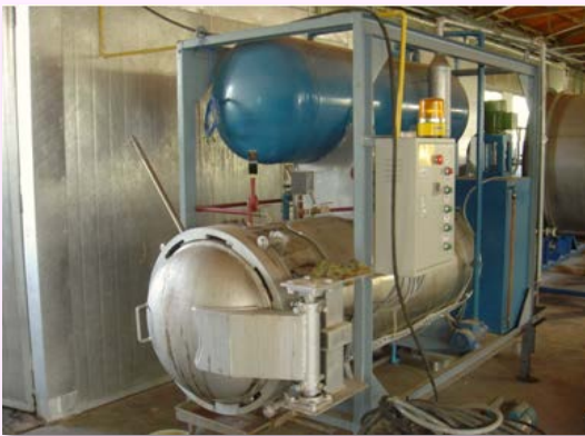
รูปที่ 1 เครื่องต้นแบบสำหรับทำกระบวนการให้ความร้อนไม้ยางพาราโดยการต้มในน้ำภายใต้ความดันที่ตัดแปลงจากรูปแบบของเครื่องอัดน้ำยาไม้ยางพาราที่ใช้ในโรงงานอุตสาหกรรม
