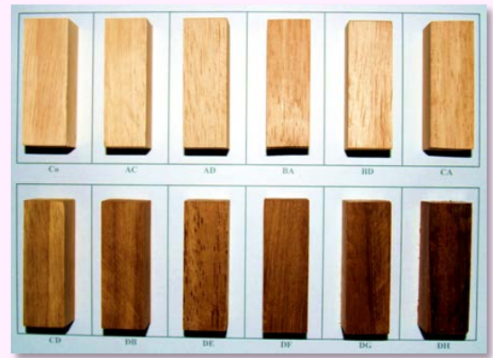
รูปที่ 2 ไม้ยางพาราหลากโทนสีที่ผ่านกระบวนการความร้อนโดยการต้มในน้ำภายใต้ความดันที่สถานะต่างๆ
